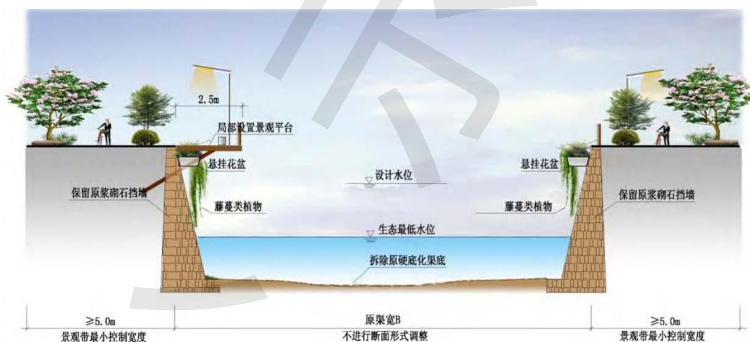
图 10.2.5-1 现状河道改造示意图（两侧用地受限-纯景观改造）
