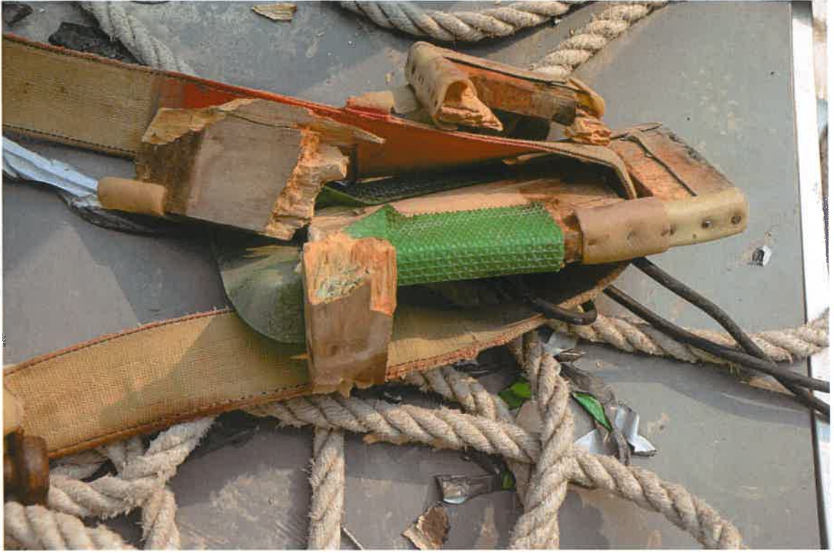
图四 韦某宾高空作业使用的座板
